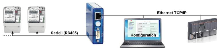
Über die serielle Schnittstelle des Zählers werden zyklisch die aktuellen Werte aller angeschlossenen Zähler ausgelesen und für das MODBUS®-TCP-Protokoll aufbereitet, wobei mehrere Geräte gleichzeitig auf die Daten zugreifen können. In den Zählern wird auf die frei konfigurierbare Servicetabelle TS zugegriffen. Die Werte aus diesen Tabellen stehen dann auf festen Registeradressen zur Verfügung. Die Zuordnung der Zähler zu den MODBUS®-Geräteadressen erfolgt in der Konfiguration.
