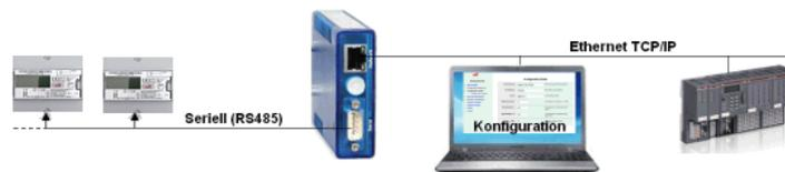
Über die serielle Schnittstelle des Zählers werden zyklisch die aktuellen Werte aller angeschlossenen Zähler ausgelesen und für das MODBUS®-TCP-Protokoll aufbereitet, wobei mehrere Geräte gleichzeitig auf die Daten zugreifen können. Die Zuordnung der Zähler zu den MODBUS®-Geräteadressen erfolgt in der Konfiguration. Eine Zeitsynchronisierung erfolgt automatisch über einen einzubindenden NTP-Server.
